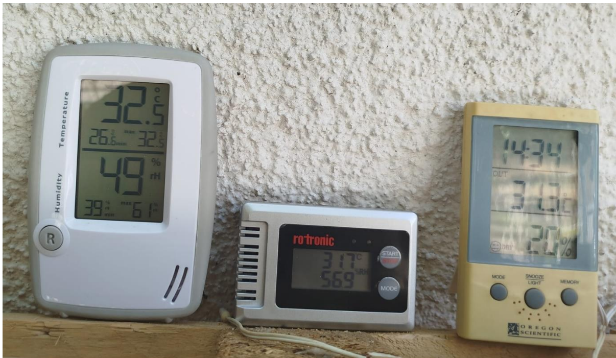
Slika 33. Testiranje rada starih termohigrometara s novim atestiranim uređajem u sredini.
