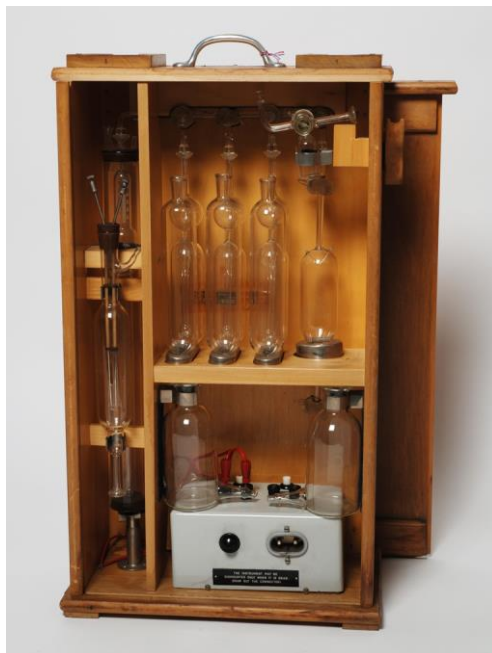
Orsatov aparat za analizu plinova
