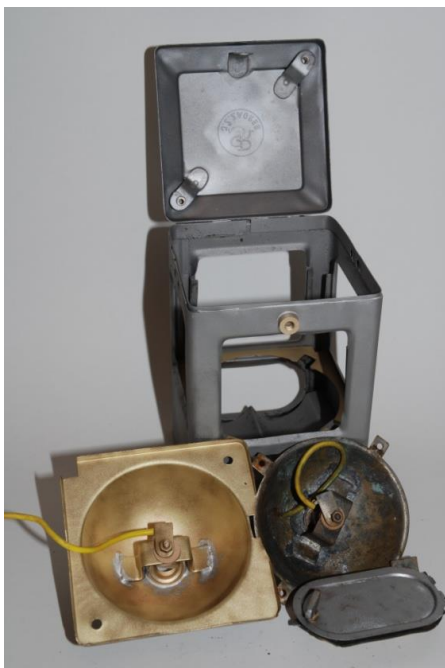
Željeznička svjetiljka - stanje nakon čišćenja
