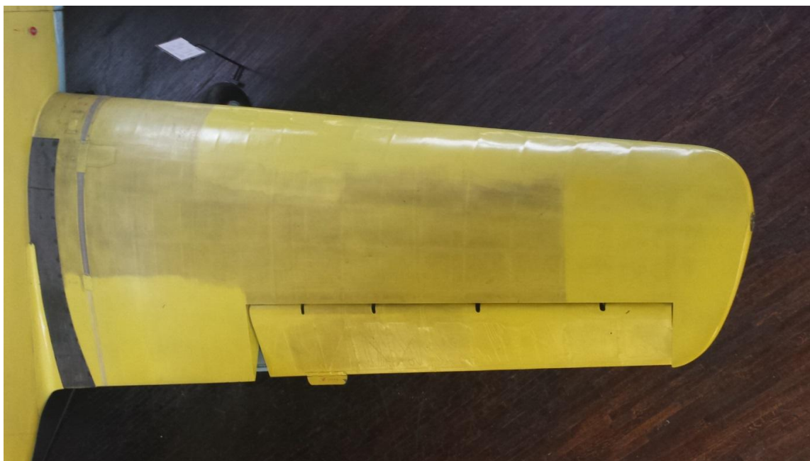
Detalj čišćenja avionskog krila- AERO 3 nano spužvama
